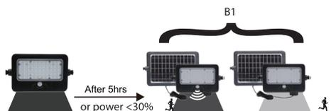
**Mode B2:** Appuyez sur le bouton une deuxième fois, le projecteur s'allumera automatiquement et restera à 100% de la luminosité (1100lm - mode détection inhibé) pendant 5 heures. Après 5 heures ou lorsque la capacité de la batterie est inférieure à 30%, il passe en mode B1.
